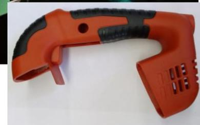
Компьютерное управление операциями литья под давлением алюминиевых сплавов и стеклонаполненного полиамида исключает человеческий фактор и обеспечивает постоянство режимов технологического процесса, улучшая качество отливок.
