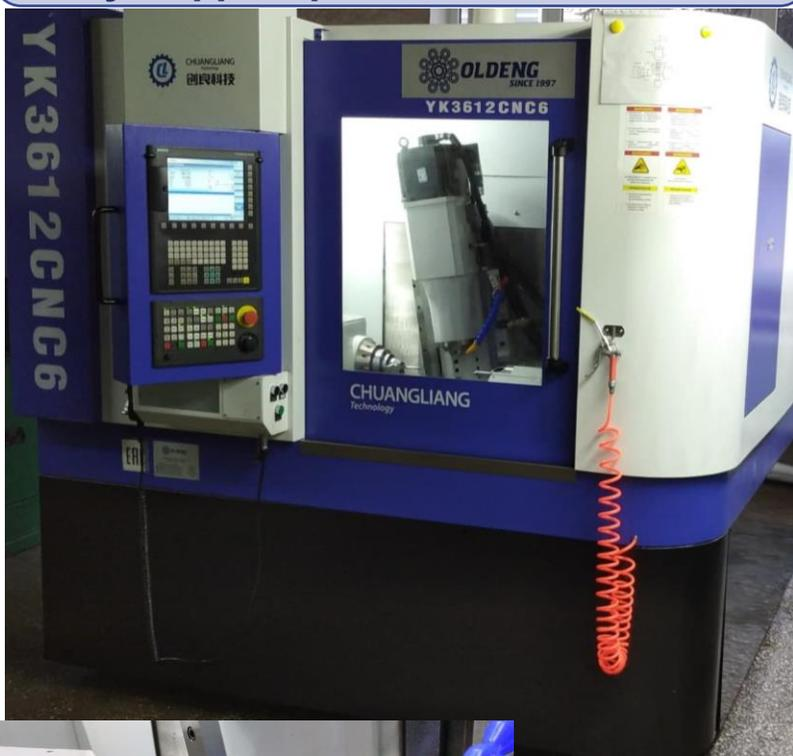
Освоение технологии изготовления зубчатой пары с круговым зубом методами механической обработки и порошковой металлургии
