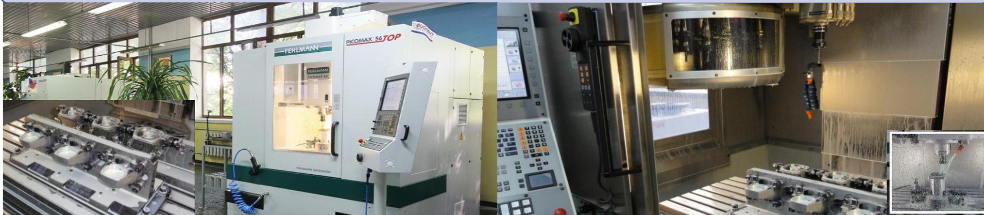
Изготовление деталей тел вращения на двухшпиндельных автоматах продольного точения
